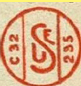
1957 USE-Kennzeichnung gedruckt mit Standardnummer (C32) und Herstelleridentifikationsnummer (295)
