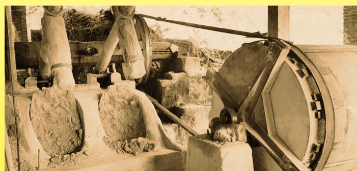
Herkömmliche Produktionsmaschinen (( 水碓 shui dui) zur Erzeugung von Pulvern für die Herstellung von Elektroporzellan (Privatsammlung)
