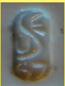
1932 USE-Kennzeichnung auf Maure-Reihenklemmen aus Porzellan
