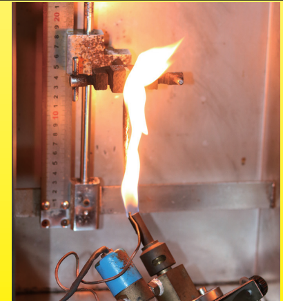
Prüflinge während der Prüfung laut UL94 V-0
